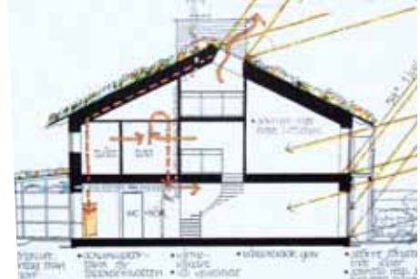
Figuur 51: Passieve zonne-energie in 20 passiefhuizen, Göteborg, Zweden, doorsnede.
