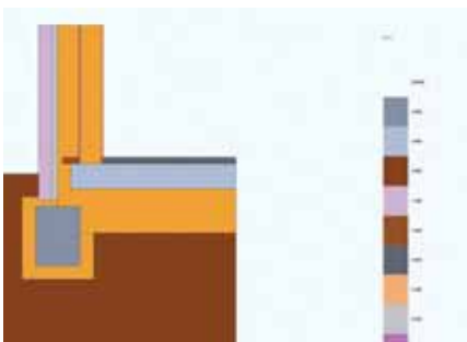
Variante 2, idem variante 1, waarbij funderingsstrook is ingepakt met isolatie ( \lambda = 0,05 \text{ W/mK} ).
